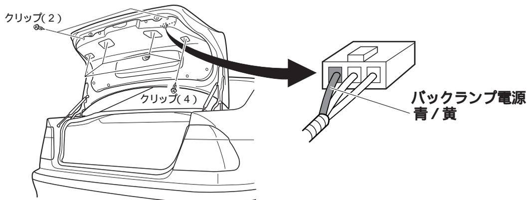
青 / 黄の線にバックセンサー入力コードを接続します。
